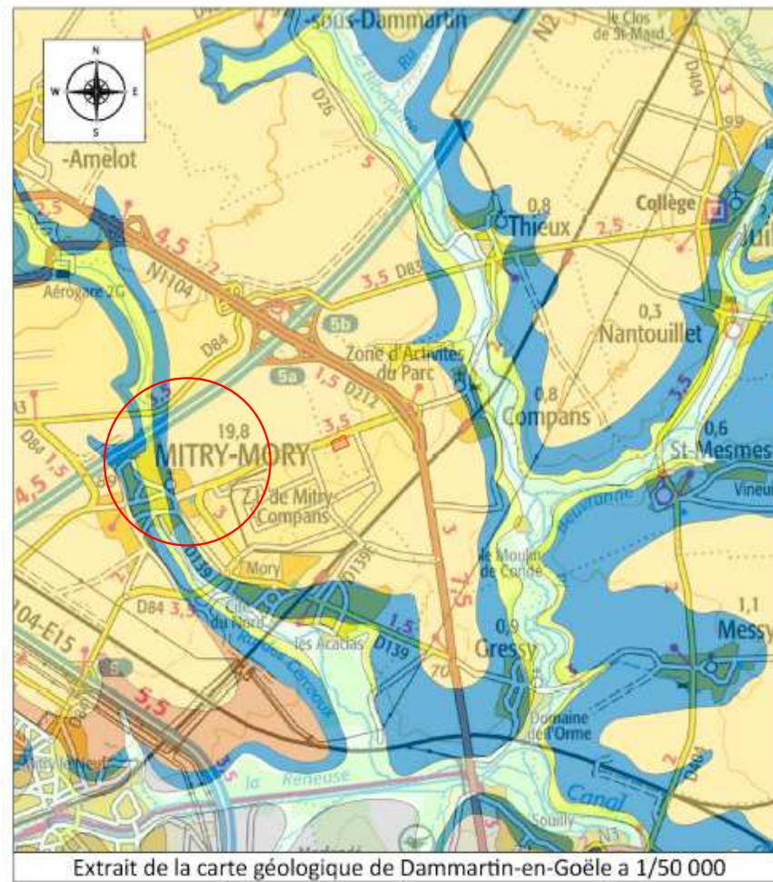
**Le sens d'écoulement des eaux souterraines est du nord est vers le sud est.
